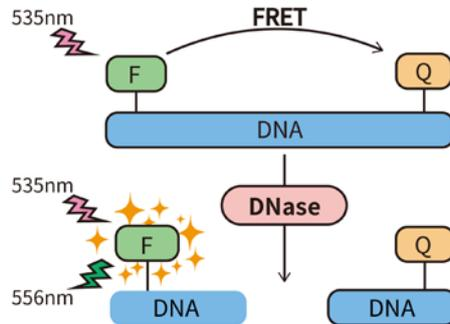
图1. 碧云天DNase活性荧光检测试剂盒检测原理图。
